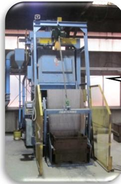
白鉄ローラー仕上げ中。集塵機を設置して環境対策も行っていきます。
